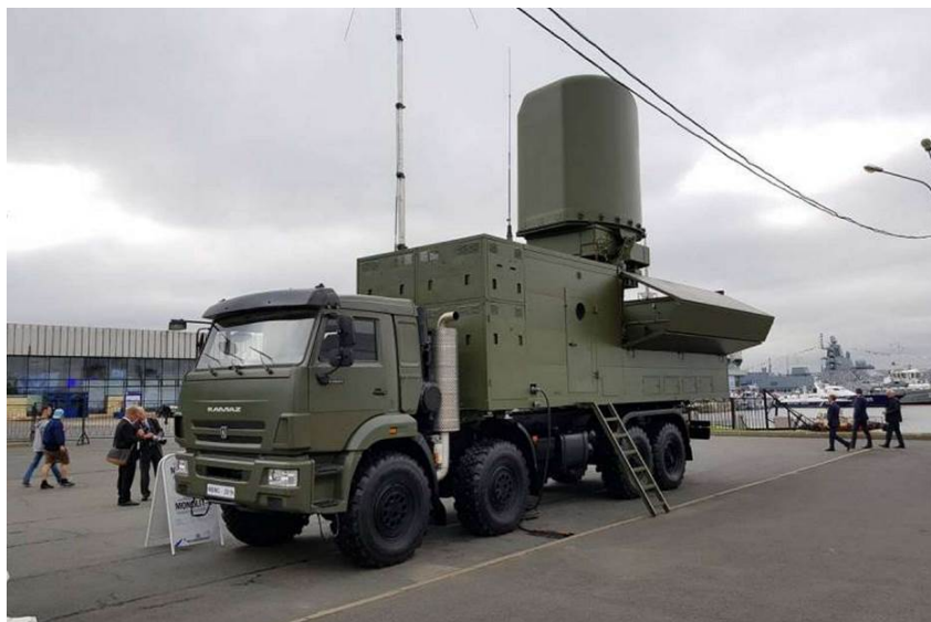
Систем Rubezh-ME обухвата самоходни командно-контролни и комуникациони пункт (SKPUS), израђен на сличној шасији, али са другачијом надградњом и опремљен радаром Monolith-B.
