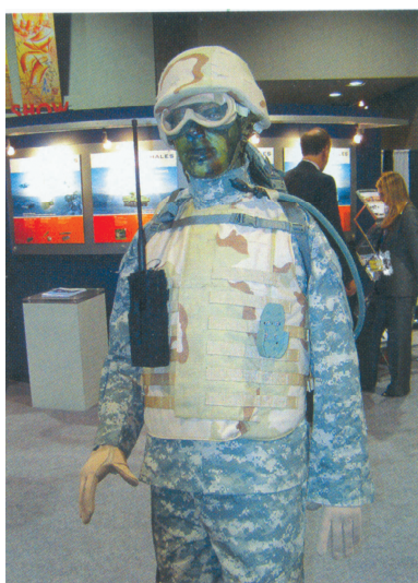
Elektronski zaštitni uređaj Storm-H okačen na ličnu opremu vojnika.
