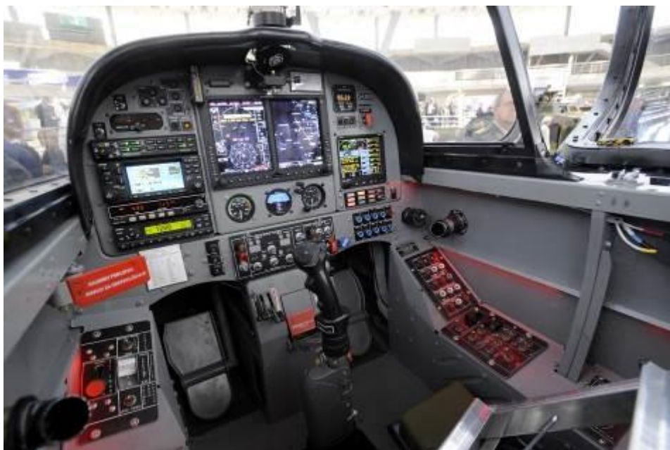
Figure 2 – Digital cockpit of the Lasta aircraft Рис. 2 – Стеклянная кабина самолета „Ласта“ Слика 2 – Дигитални кабински простор авиона „ласта“
