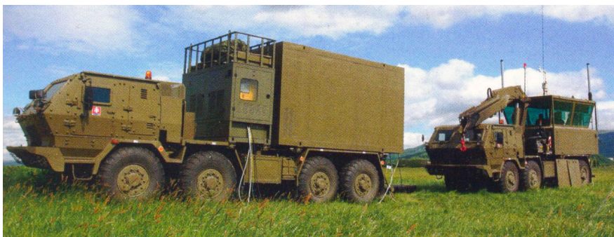
Sistem se transportuje sa dva vozila: TMPS1 (levo) i TMPS2 (desno) sa ugrađenim kranom.
