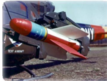
Slika 6 – SS.11 projektil montiran na helikopter
